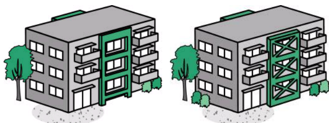
フレーム架構補強
