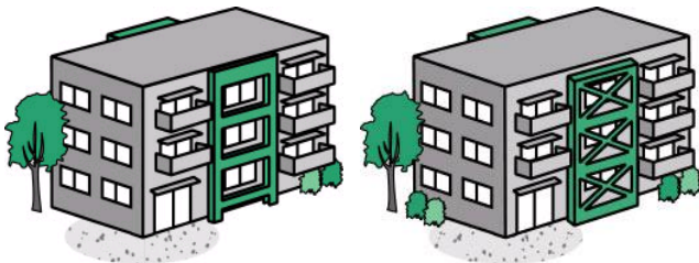
フレーム架構補強
