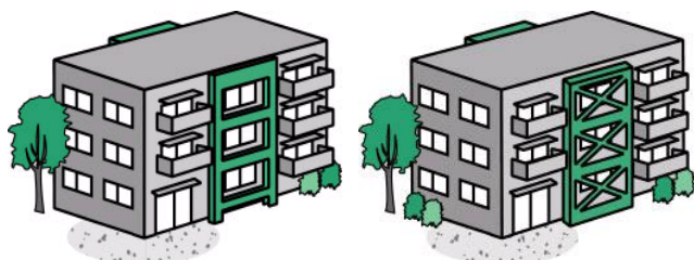
フレーム架構補強
