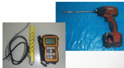
超音波探傷試験ユニット ●32
