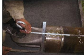
ブレース寸法 検査
