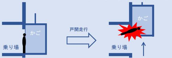
平成18年6月に東京都港区の共同住宅で発生した高校生の死亡事故を受け、平成21年9月28日以降に設置するエレベーターには「戸開走行保護装置」の設置が義務付けられています。一方、平成21年9月28日より前に設置されたエレベーターには、戸開走行保護装置の設置の義務はありませんが、既設エレベーターの安全性確保のために、戸開走行保護装置の積極的な取り付けをお願いいたします。既設エレベーターへの取付けの可否、具体的な改修方法、改修期間、改修費用については、エレベーターの製造業者、保守点検業者にご相談ください。
